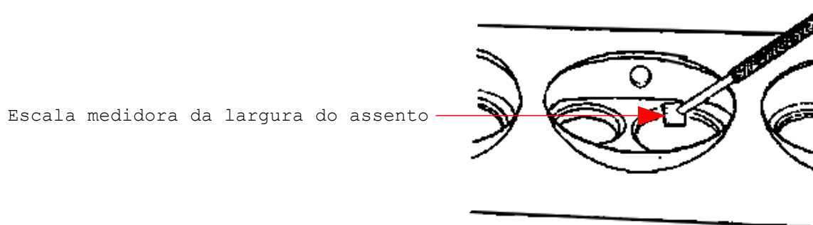
Figura 07: Largura dos assentos das válvulas.
