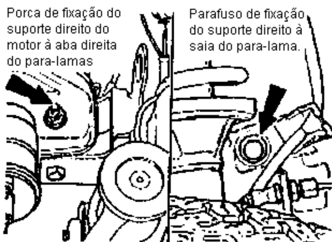
Figura 16: Fixação do suporte direito do motor.
