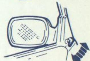
Comando elétrico - **Geo / XRE** ajuste os espelhos retrovisores externos, à esquerda e à direita, acionando o botão de comando posicionado no painel.
