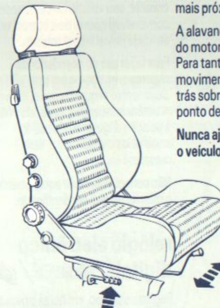
Os encostos de cabeça são reguláveis na altura e ângulo de assentamento. Ajuste-os de forma a posicioná-los exatamente atrás da cabeça, e nunca do pescoço.
