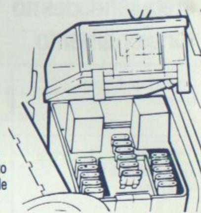
Se houver a queima repetida de algum fusível, recorra a um Distribuidor Ford a fim de verificar a causa da sobrecarga no circuito.
