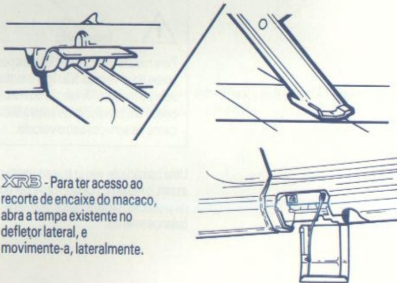
**XRB** - Para ter acesso ao recorte de encaixe do macaco, abra a tampa existente no defletor lateral, e movimente-a, lateralmente.
