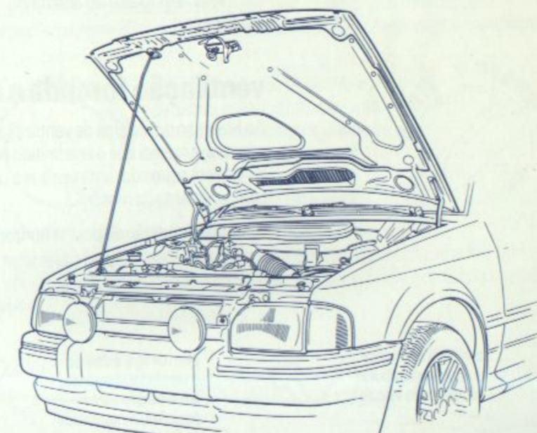
A alavanca da trava de segurança, sob a tampa do compartimento do motor, deve ser, então, acionada, para permitir que a mesma se abra totalmente; uma vez levantada, suporte-a com a haste da sustentação.
