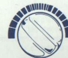
Utilizando o botão de controle da distribuição do ar em conjunto com o do controle da temperatura, o ar pode ser distribuído para o interior do veículo ou desembaçador do pára-brisa.
