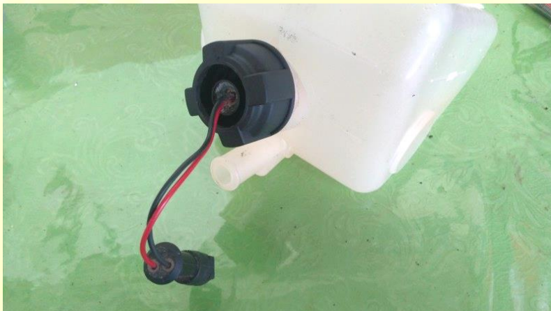
Figs. 12.8 e 12.9: Localização original do sensor: Reservatório dos primeiros modelos e reservatório dos modelos mais modernos.
