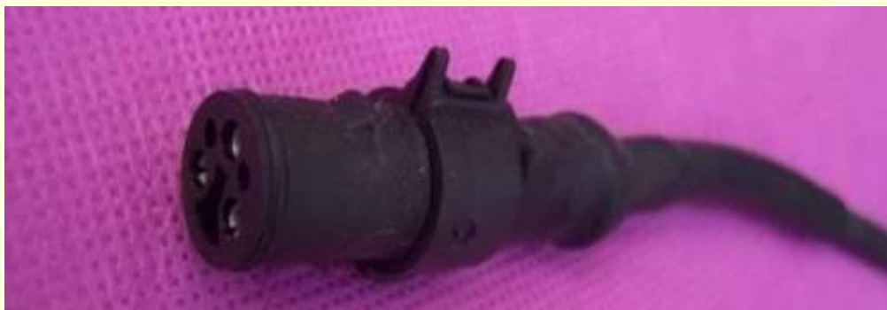
Fig. 12.19: Conector AMP Econoseal original de sensor de pastilha de freio para Escort.
