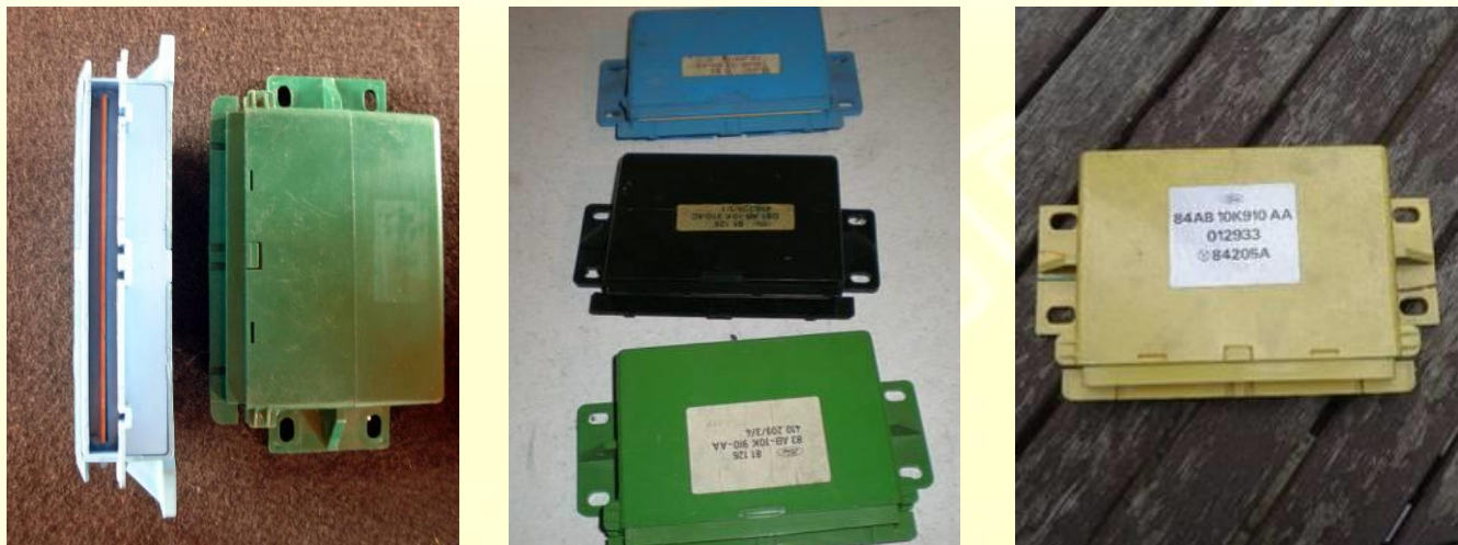
Fig. 6.3: Aspecto visual dos módulos check control: Ao comprar um, verificar o encaixe da placa, se a mesma tem 22 terminais ou se ao menos tem o lugar reservado aos 22, para não cair no erro de comprar um módulo de amortecedor eletrônico que tem o box plástico idêntico.
