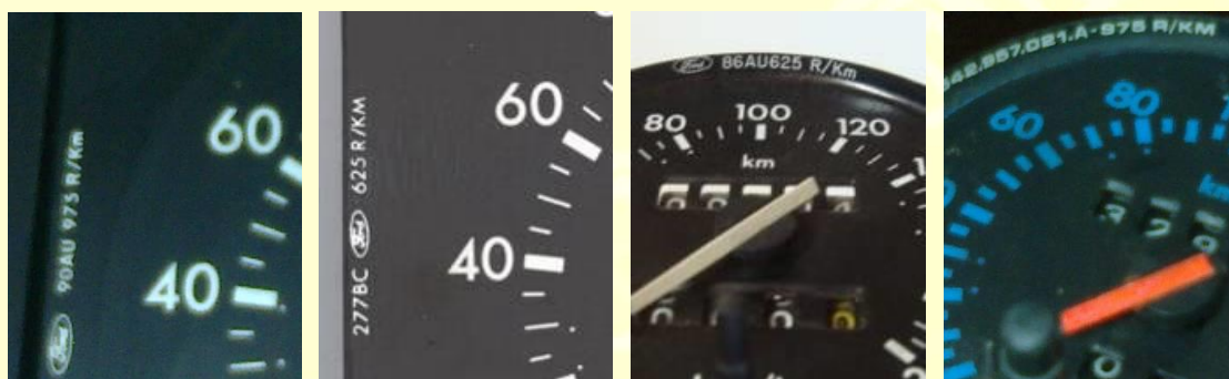
Fig. 3.1: Diferenças entre os velocímetros quanto às rotações por quilômetro
