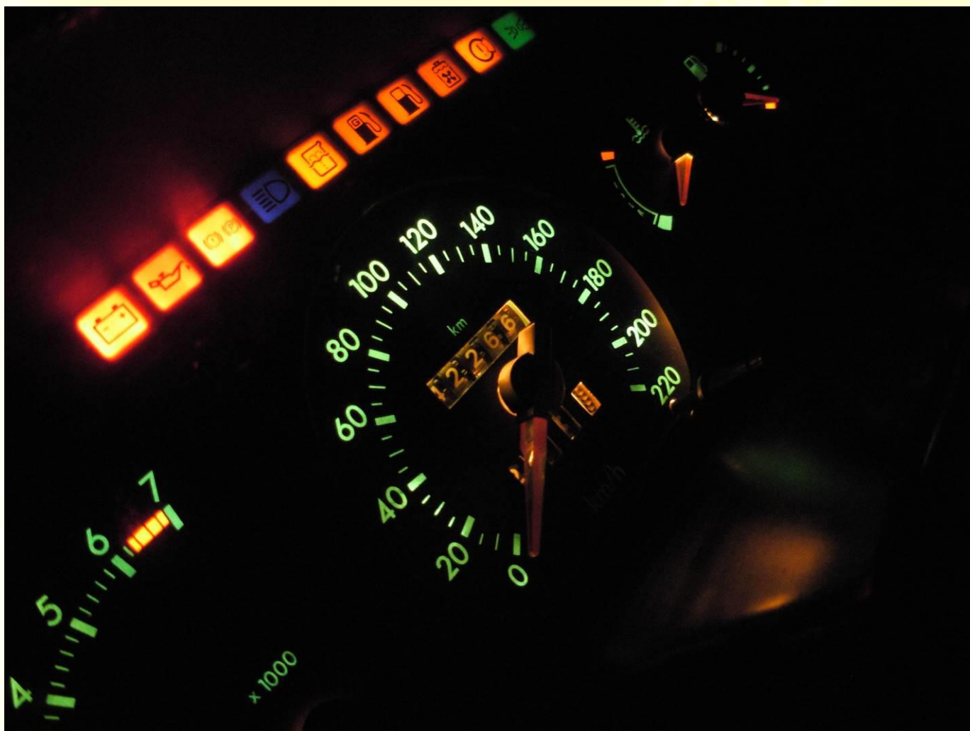
Fig. 15.2: Escort Hobby 1.0 com Painel de XR3 a Álcool sem desembaçador adaptado conforme descrito no capítulo 11 e módulo do check control adaptado totalmente funcional.
