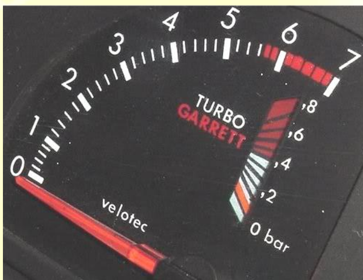
Fig. 5.1: Tacômetro de um MK4 com indicador de pressão de turbo Garret. Essas versões de Escort turbo eram disponibilizadas apenas em algumas concessionárias.
