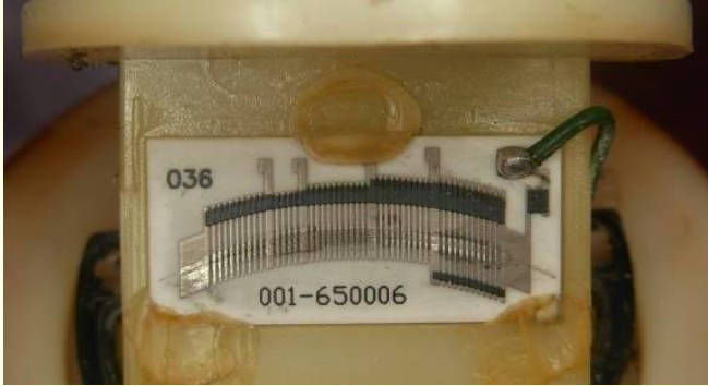
Figs. 7.11 e 7.12: Um circuito elétrico de boia sem e com alarme em detalhe.
