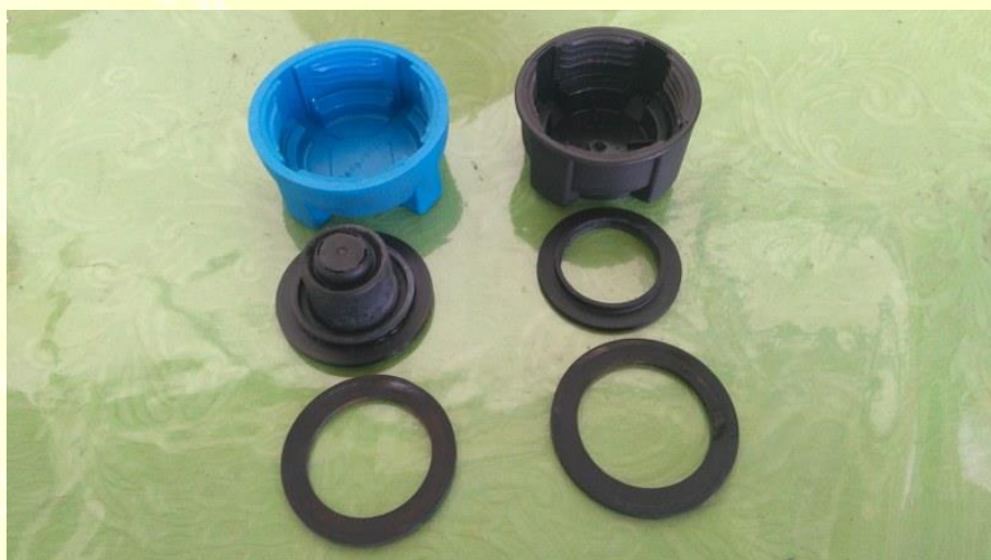
Fig. 12.11: Duas tampas de reservatório desmontadas. A da direita já teve o seu miolo eliminado com auxílio de uma microrretífica. Reservar apenas o anel plástico.
