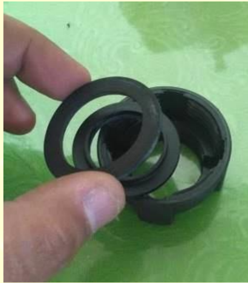
Fig. 12.12: Furo realizado na tampa com a microrretífica. Notar que a borda do corte do furo coincide com a marcação da tampa.
