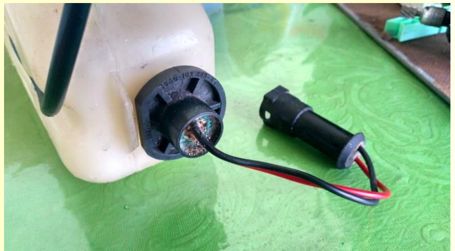
Fig.12.7: Sensor instalado depois de perfurar o reservatório e fabricar a bucha de vedação. Notar que o sensor fica alinhado paralelamente à aleta de estabilização para que este não gire.
