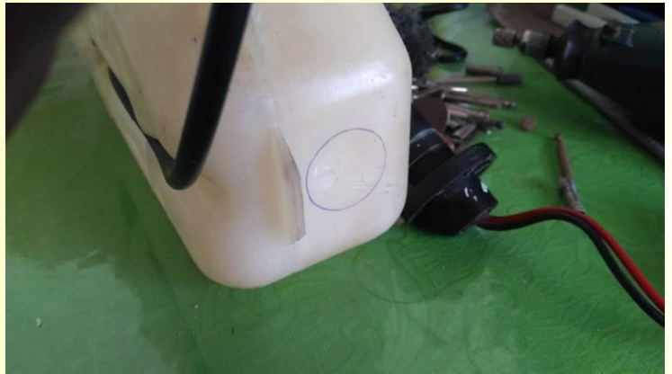
Figs.12.4 e 12.5: Posicionamento do sensor do tanque de água do reservatório de limpeza do para-brisas.
