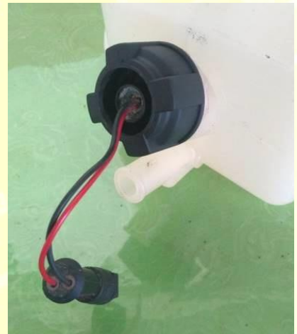
Fig. 12.15: Anel de borracha confeccionado para vedar a interface reservatório/sensor. Para esta finalidade, usar uma câmara de ar.
