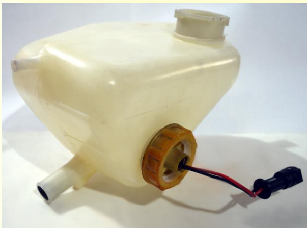
Figs. 12.8 e 12.9: Localização original do sensor: Reservatório dos primeiros modelos e reservatório dos modelos mais modernos.
