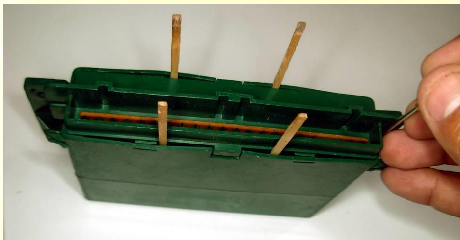
Fig. 6.4: Macete para abrir as caixas de módulos do check control.
