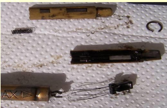
Figs. 7.13 e 7.14, 7.15 e 7.16: Fotos cedidas pelo usuário Killer sanjorge, mostrando o sensor de nível de óleo do Cárter de um MK3.
