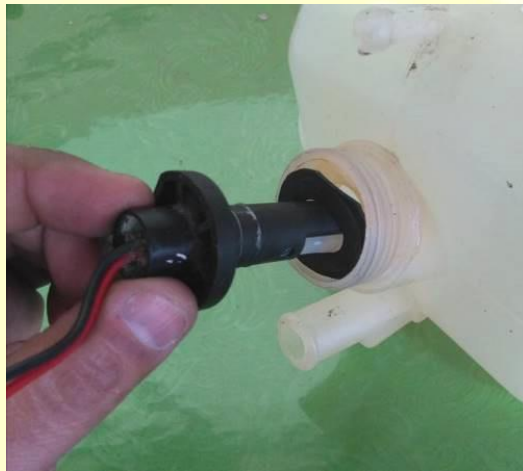
Fig. 12.14: Tampa remontada com o anel plástico e anel de borracha.
