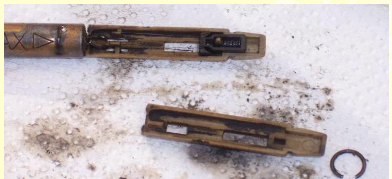
Figs. 7.13 e 7.14, 7.15 e 7.16: Fotos cedidas pelo usuário Killer sanjorge, mostrando o sensor de nível de óleo do Cárter de um MK3.
