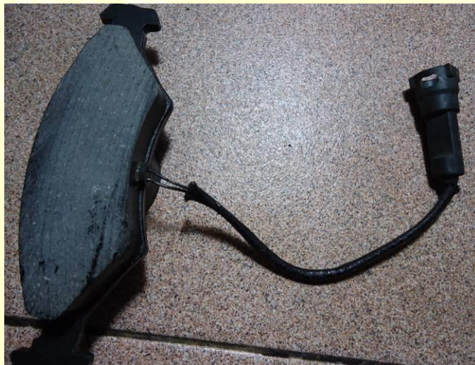
Figs. 7.5 e 7.6: Sensores de desgaste das pastilhas de freio ou ainda, pastilhas de freio com sensor:
