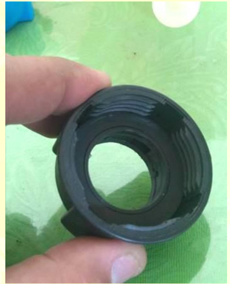
Fig. 12.12: Furo realizado na tampa com a microrretífica. Notar que a borda do corte do furo coincide com a marcação da tampa.
