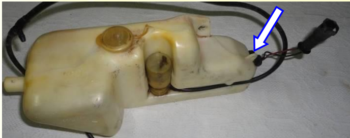
Figs.12.4 e 12.5: Posicionamento do sensor do tanque de água do reservatório de limpeza do para-brisas.
