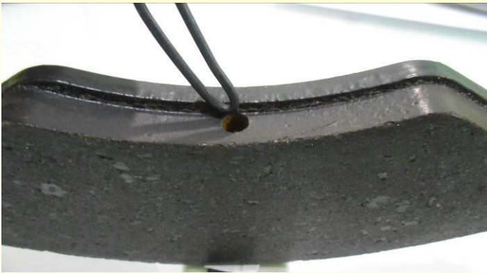
Figs 7.9 e 7.10: instalação do fio novo na pastilha de freio comum
