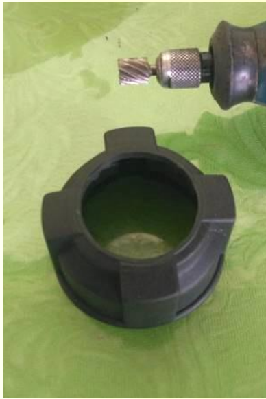
Fig. 12.12: Furo realizado na tampa com a microrretífica. Notar que a borda do corte do furo coincide com a marcação da tampa.
