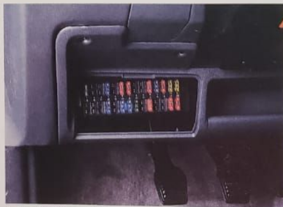
Caixa de fusíveis no interior.
