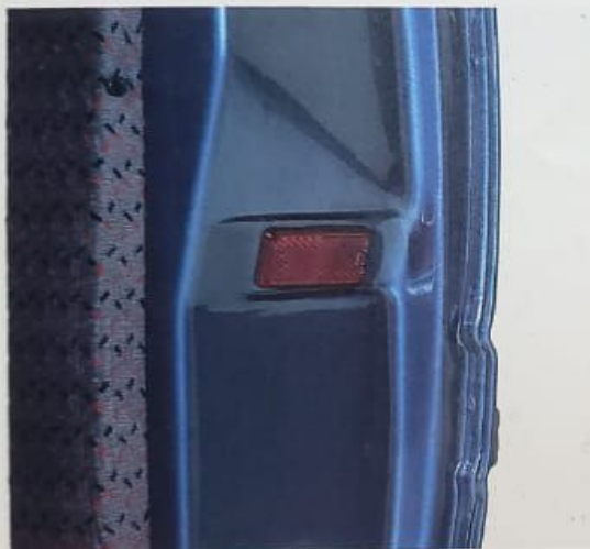
Sinalização de segurança nas portas.
